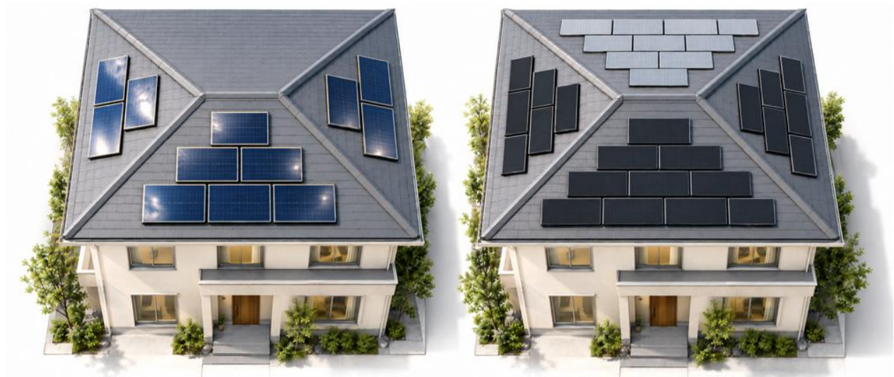
図1：従来型メイン 460W による 3 面設置と、防眩型による 4 面設置の比較イメージ。
